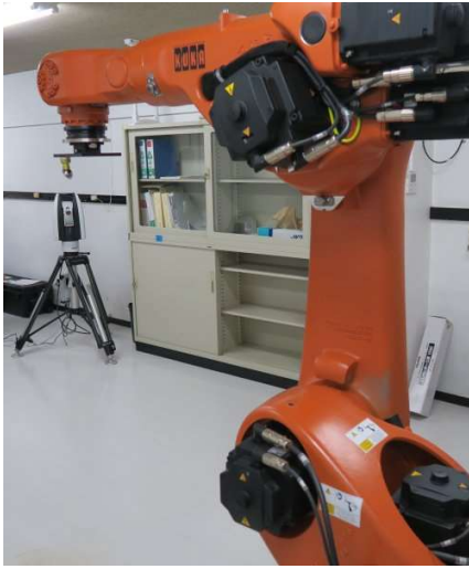
図1 産業用ロボット (KUKA 社). レーザトラッカで精度測定をしている写真です.
